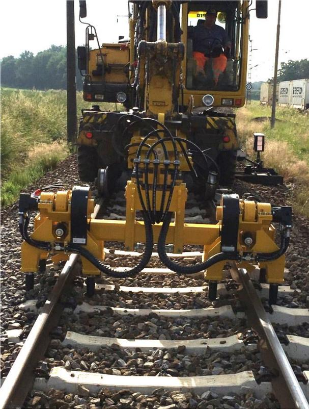
Mittels eines Rotators wird das Anbaugerät der jeweiligen Schwellenlage angepasst. Alle Bedienungsvorgänge werden vom Baggerfahrer aus der Kabine durchgeführt.
