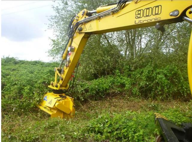
Der Anwendungsbereich des Mulchers erstreckt sich auf Gras und Gehölzrückschnittarbeiten. Beim Mulchen von Gehölz kann der Eingriffswinkel durch eine Klappe an der Vorderseite flexibel erweitert werden.
