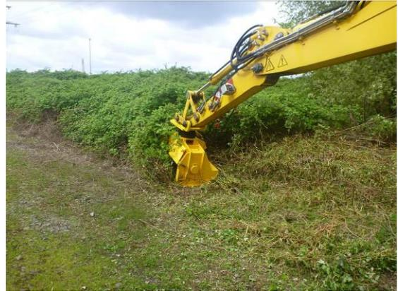
Für den Betrieb des Mulchers sind keine Änderungen oder Erweiterungen an der Baggerhydraulik erforderlich. Mit dem Anbausatz für das Stopfaggregat AST-8 können alle erforderlichen Bewegungen ausgeführt
