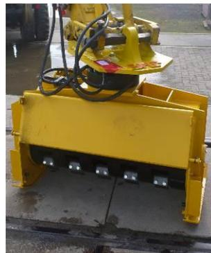
Die zeitsparende Montage am Bagger oder Kran wird durch Schnellverschlusskupplungen an den Hydraulikschläuchen sowie durch die Möglichkeit des Einsatzes von Schnellwechselsystemen für den Mulcher erreicht.
